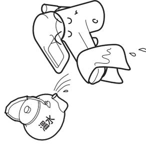
即使進行排水，可能因附著於出水口濾網處的水滴結凍，再次通水後短時間內，有不出水的情形。此時，請以毛巾等布料包覆，緩緩倒入溫水讓其滲入。
