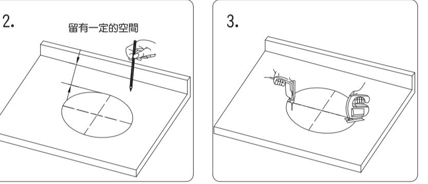
根據安裝圖紙，定位洗面器的安裝位置，用筆沿着洗面器切割圖紙的邊緣將洗面器輪廓與安裝孔描繪在檯面上。
