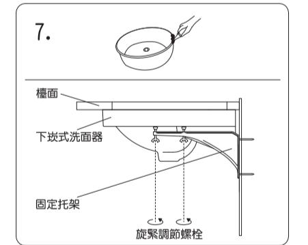
檢查校驗後，把洗面器放平，在洗面器邊緣的凹槽上填上防水密封材料。再把洗面器小心的放到檯面下，對準安裝口，與先前的記號相校對並向上壓緊、旋緊固定托架的調節螺栓，使洗面器與檯面緊密連接。
