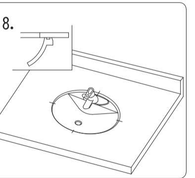
等密封材料硬化後，將龍頭按照其說明書上的要求指示安裝到檯面上。
