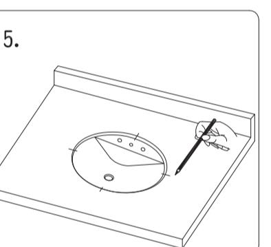
根據洗面器的尺寸及安裝位置，將安裝托架牢固並正確的安裝於檯面上。建議台面到地面的距離為820mm。
