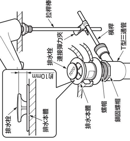
⑤ 將擰入**排水栓**本體的**鎖固螺帽**（沒有凸緣的螺帽）**鎖回T型三通管側**，並**鎖緊**至使**T型三通管**不會旋轉。
