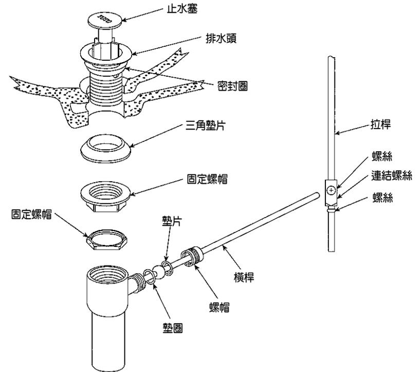
※將橫桿穿過連結螺絲，調整連結螺絲的位置，使止水塞能正常升降後，拴緊螺絲。
