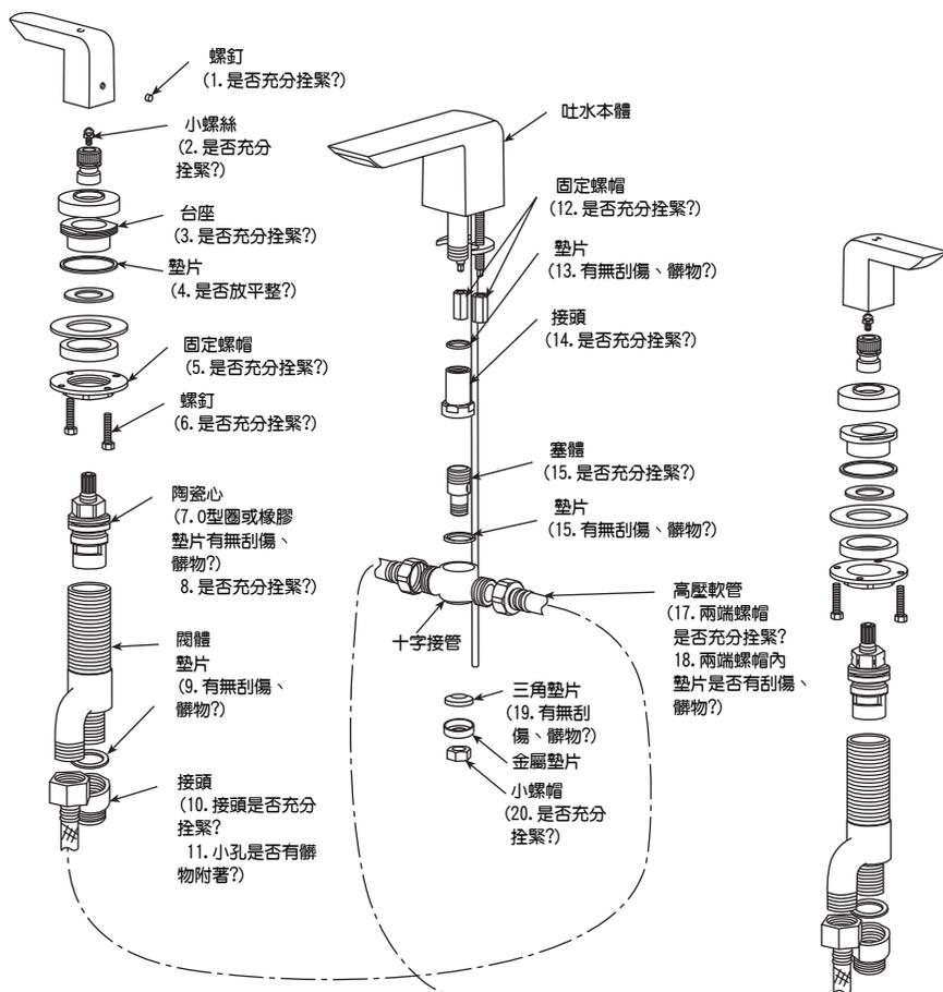
※製品構造不同时，請參照“水栓的安裝”部分進行拆卸。
