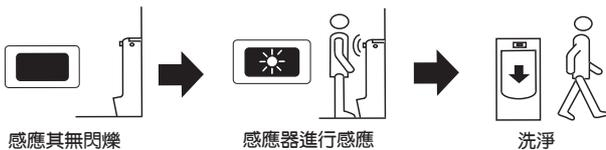
※無人體感應的狀態下，光電感應器亮燈時，光電感應器會自動調整感應距離。請耐心等待至指示燈熄燈為止。(詳細內容，請確認「10. 光電感應器感應距離調整」)
