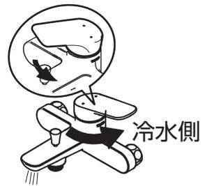
使用完高溫熱水後，請讓冷水短暫流出一段時間
