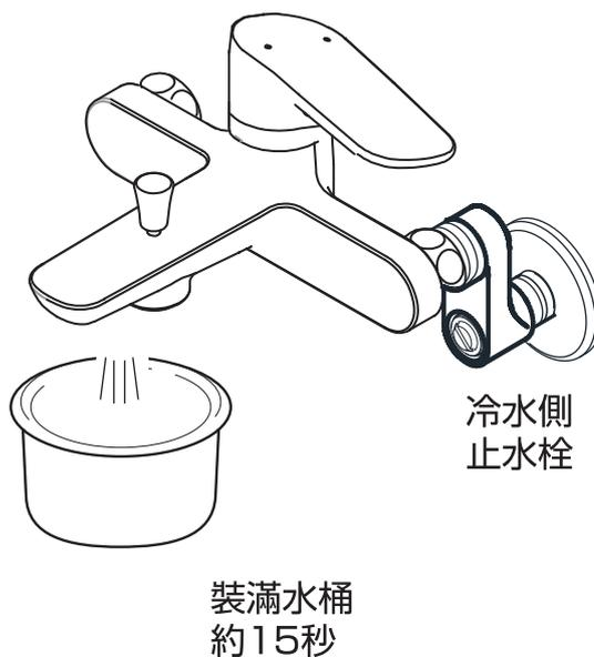
3. 將把手向熱水側旋轉到底，如同 2. 的步驟，使用熱水側止水栓調節流量。
