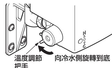
⑧ 將冷水側的止水栓慢慢的打開，調節流量。
