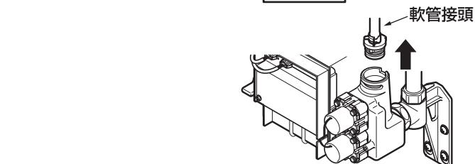
⑤將固定扣環從連接軟管接頭拆下，
