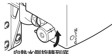
⑩ 將熱水側的止水栓轉到全開，確認出水溫度在42°C以下。
