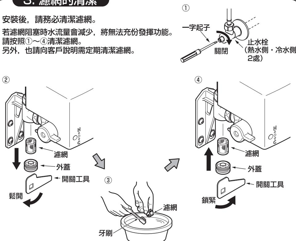
※關閉止水栓後，請務必使用附屬的開關工具 **拆下壁面安裝腳外蓋，拆取下濾網**。
