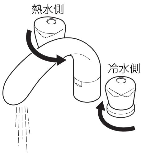
1. 停止配管部止水栓等處的給水，
