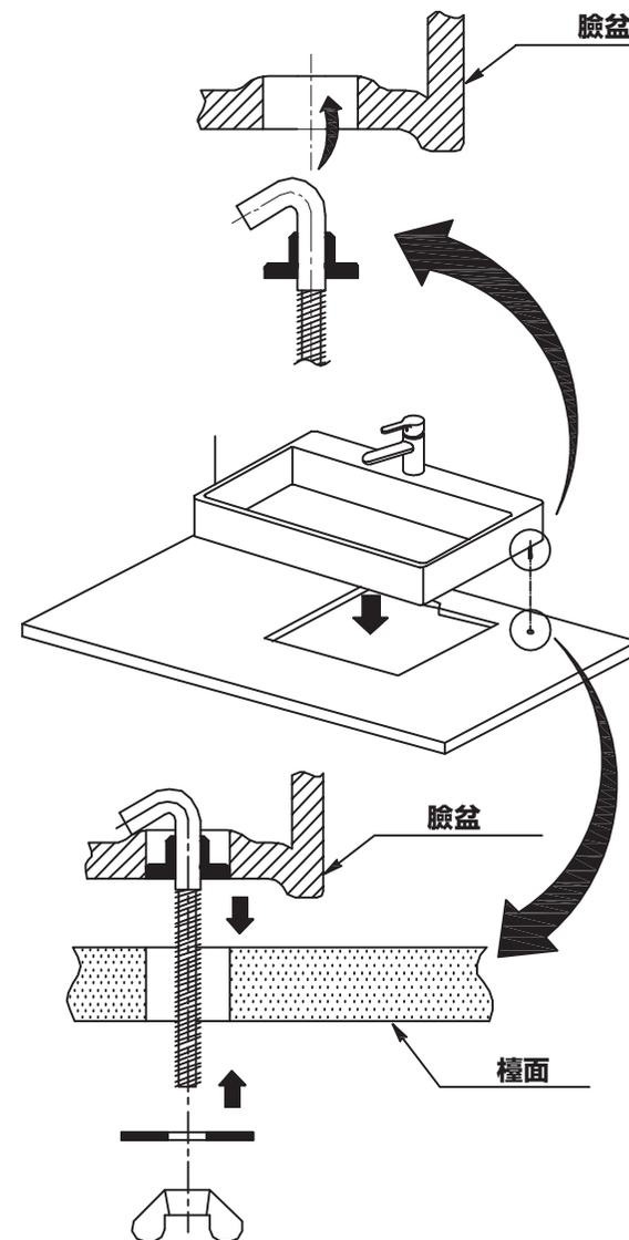
6. 使用矽利康等密封材料填補臉盆與檯面的間隙。
