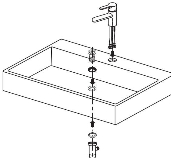
5. 將固定金具插入金具安裝孔後，放上臉盆並以螺帽固定。
