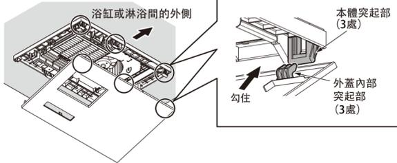
(3) 如右圖○部所示，外蓋卡扣卡住本體卡扣，並向天花板方向推到底。
