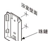
(2) 在標示固定螺絲孔的位置開好φ6mm、深度40mm的孔，注入矽膠後固定膨脹管。
