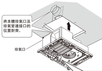
將本體落下防止金具完全推入並擰緊固定螺絲後，可以暫時讓本體掛在吊頂上不掉下來。
