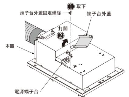
(2) 將電源線φ2.0mm的單芯線(VVF電纜線)以及接地線(銅線φ1.6-2.0mm) 連接到端子上。
