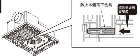
(2) 如右圖○部所示，外蓋內部突起部分（3處）插入本體突起部（3處）。
