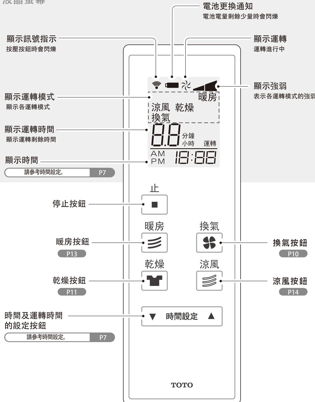
※務必將液晶螢幕的保護膜剝除後再使用
