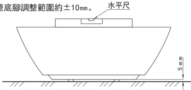
2. 浴缸調至水平後，請鎖緊調整底腳的螺母 A。（調整底腳的方法，參照下圖）
