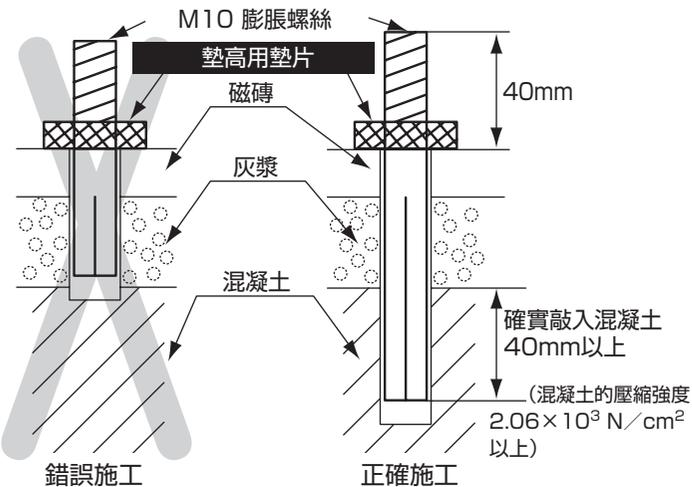
※若包裝內的膨脹螺絲無法敲入40mm以上時，請使用市售的膨脹螺絲M10(螺絲、SUS製)。
