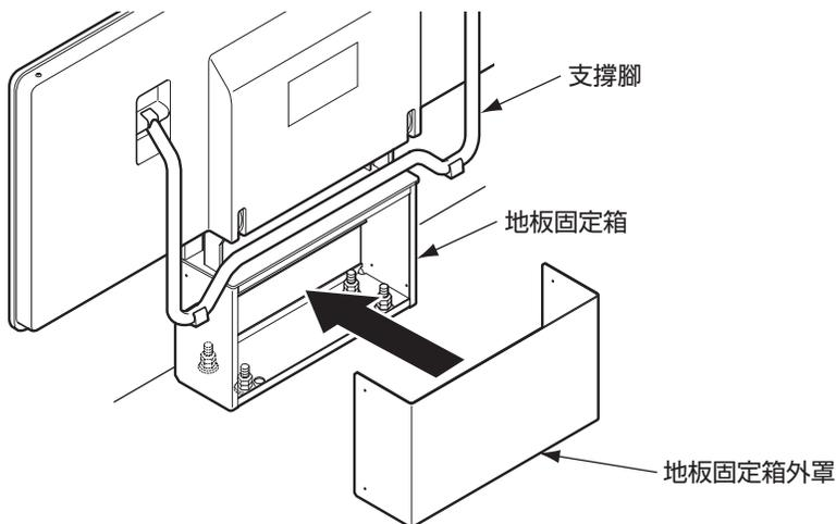
②使用4個M4六角螺栓固定地板固定箱外罩。
