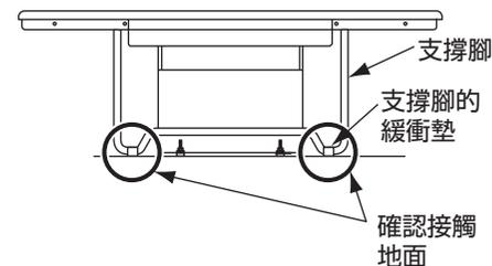
② 請在4處的膨脹螺絲追加M10鎖固螺帽鎖緊。(雙螺帽要領)
