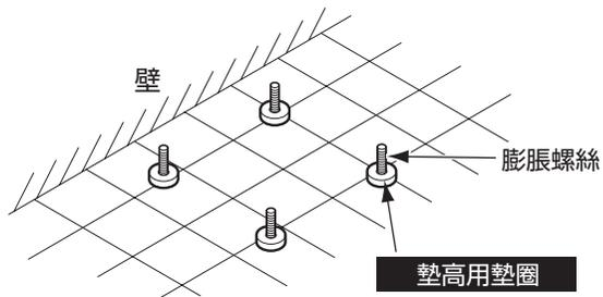
② 床墊面向壁面，地板固定箱對準膨脹螺絲的位置，使用平墊圈及M10鎖固螺帽暫時固定。
