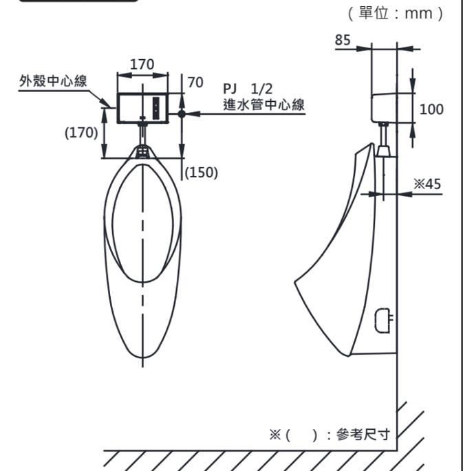
※施工完成後，本體組品之出水口中心線距施工牆面為45mm。
