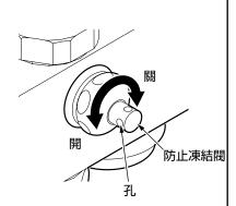
※ 冬季等可能產生凍結的時期,若未打開防止凍結閥,因內部的水沒有流動而 凍結,可能發生零件破損、故障等情形,請注意。
