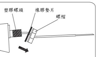
將螺帽及橡膠墊片從塑膠螺頭上逆時針轉動，並沿橫桿取下。
