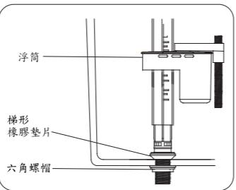
轉開六角螺帽，將進水器放入水箱的進水口，確認梯型橡膠墊片處於圖示位置。套上六角螺帽並鎖緊。
