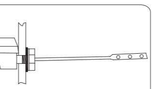
將橡膠墊片與螺帽沿橫桿套入，調整把手角度，使其前端凸出，並鎖緊螺帽，固定把手組。
