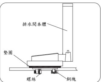
將排水閥本體放入排水口，調整其角度，使將來安裝的排水蓋鏈條不受阻礙，鎖緊螺絲使銅塊緊貼水箱內壁，固定排水閥本體。
