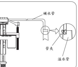
如上圖所示：將補水管一端插入進水器補水孔中，另一段插入排水閥溢水管內，並用管夾固定。
