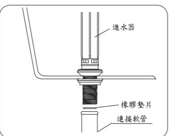
進水器與進水軟管連接時，請先放水沖掉進水軟管內異物，然後將止水栓連接進水軟管及進水器。
