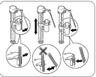
調整水位：將浮筒上紅色扣環打開，將浮筒往上或往下調整至適當位置，調整完畢後，將紅色扣環及螺桿扣回原位。
