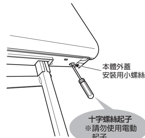
②將支撐腳外蓋安裝於支撐腳框架上，使用支撐腳
