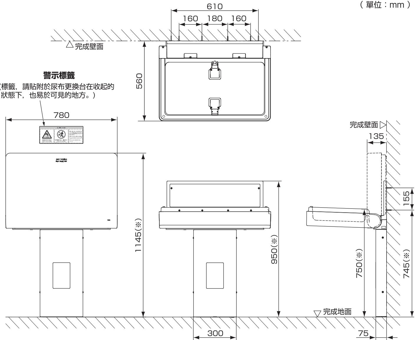
(※) 使用另售品墊高加固用墊片（型號：YPH13057），安裝高度須較一般情形高出10mm。
