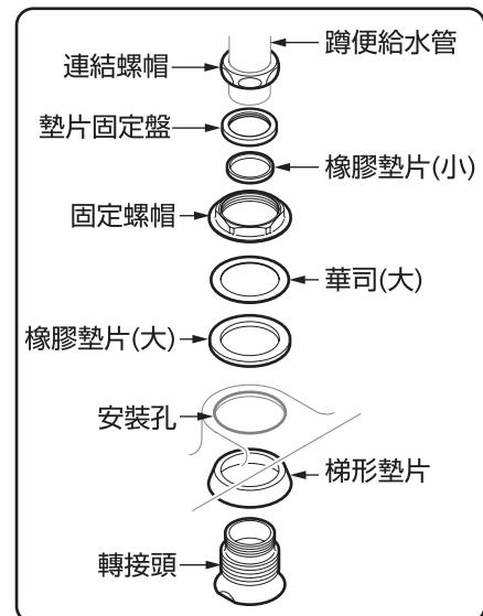
① 將連接螺帽、墊片固定盤、橡膠墊片(小)套入蹲便給水管。
