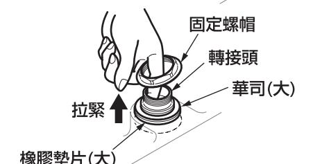
⑤ 食指穿過固定螺帽，將轉接頭朝安裝孔中心的上方拉緊，再將固定螺帽先用手鎖緊。
