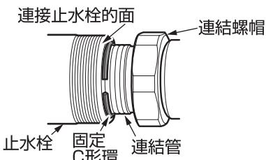
調整閥心間距離時，連結管的固定C形環須移動到連接止水栓的面為止。
