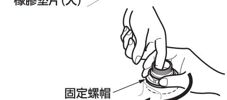
⑥ 使用扳手等工具將固定螺帽確實鎖緊。
