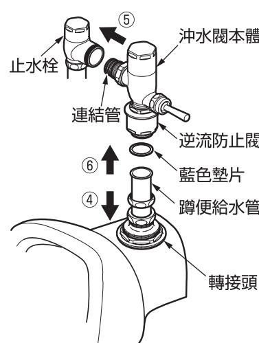
⑦ 當發生偏差時，請參考閥心間距離的調整方法，將沖水閥本體與止水栓的閥心間調整為合適的距離。
