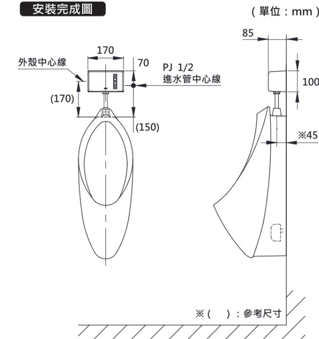
※施工完成後，請確保出水口中心距離牆面為45mm。
