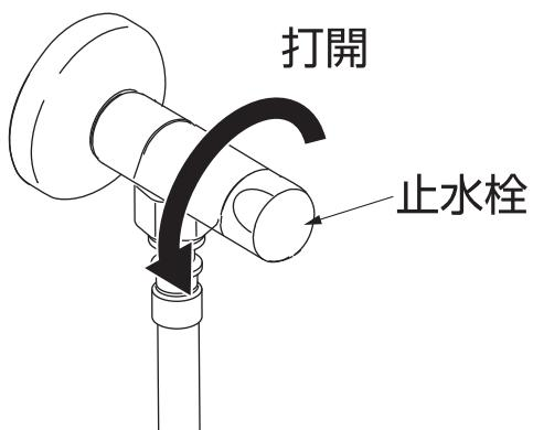
當止水栓關閉時，請逆時針旋轉，將止水栓打開。
