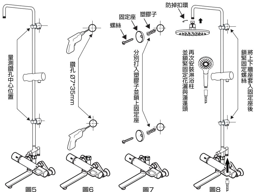
※1: 安裝後請確認各連接處是否緊密、管道是否洩露、整體安裝是否牢固，確定各部位良好後，可進行通水測試，並檢查各連接處是否漏水。
