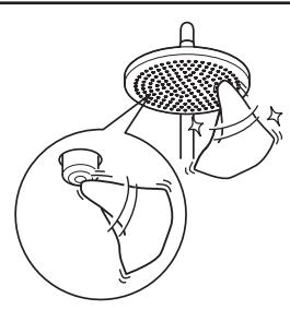
若使用時出現流線不均勻的現象，可用毛巾輕輕擦拭散水板上小橡膠的吐水口，清除異物。
