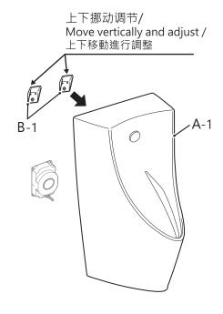
此时·如果小便器(A-1)没有达到规定高度·可拧松挂钩(B-1)的木螺钉(B-2)·在与墙壁之间塞入金属片进行调整。/
