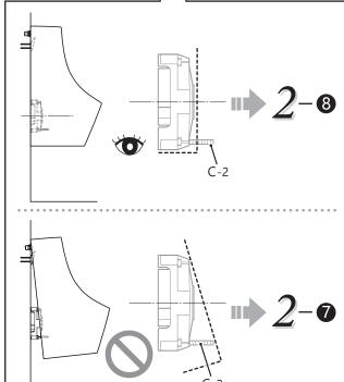
如小便器(A-1)安装不顺利时,请从后背吊钩卸下小便器,拆下供水软管后,调整后背吊钩(B-1)。/
