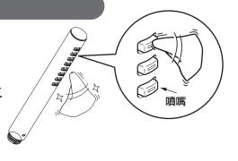
※注意:強力擦拭時,有可能造成噴嘴破損或變形而導致流線亂。
