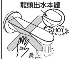
使用熱水時，務必先從冷水側打開後，再慢慢轉向熱水側調節至喜好之溫度
