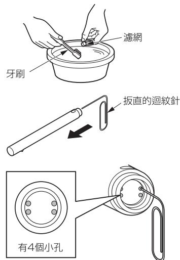
7. 取出浸泡在熱水中的給皂口，使用 $\phi 1$ 左右的針狀物(例：迴紋針)清潔阻塞給皂口小孔的皂液或異物。
