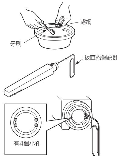
7. 取出浸泡在熱水中的給皂口，使用 $\phi 1$ 左右的針狀物(例：迴紋針)清潔阻塞給皂口小孔的皂液或異物。
