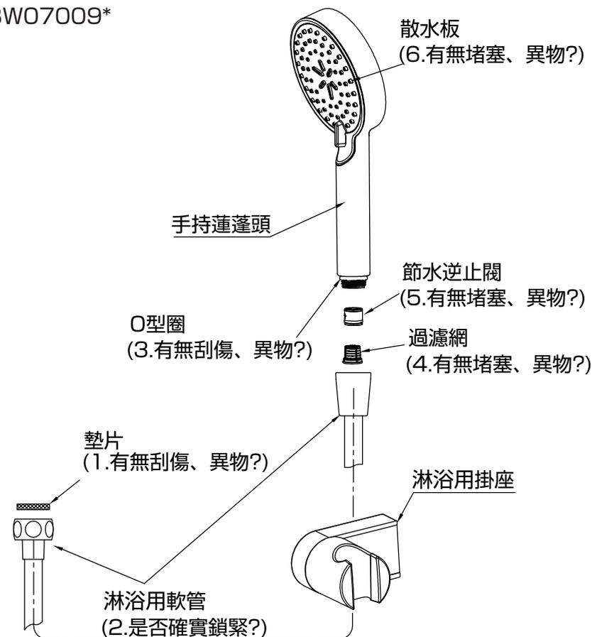
※不同型號產品的拆卸與檢查原理基本相同
