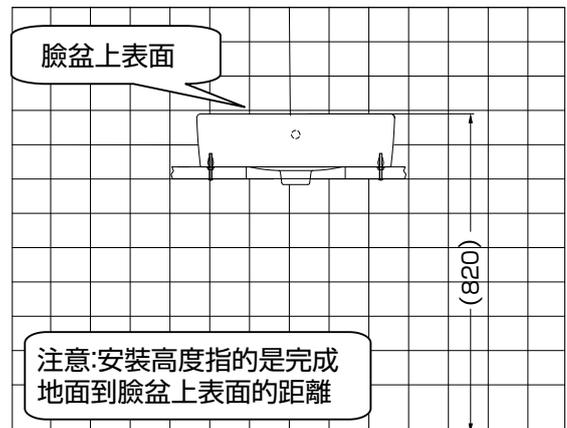
4-2 將臉盆放到安裝位置，用水平尺矯正水平位置後，用筆在牆面上標出陶瓷安裝孔的位置。
