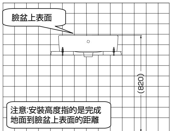
4-2 將臉盆放到安裝位置，用水平尺矯正水平位置後，用筆在牆面上標出陶瓷安裝孔的位置。
