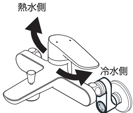
2. 請以冷水側止水栓調節流量至 15L/分。(裝滿水桶大約將近 15秒的程度。)
