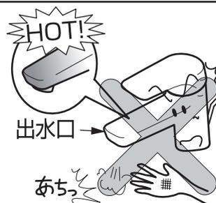
**使用熱水時，務必先從冷水側打開後，再慢慢轉向熱水側調節至喜好之溫度**
