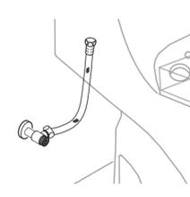
※將止水栓水平安裝，防止進水軟管折彎。
