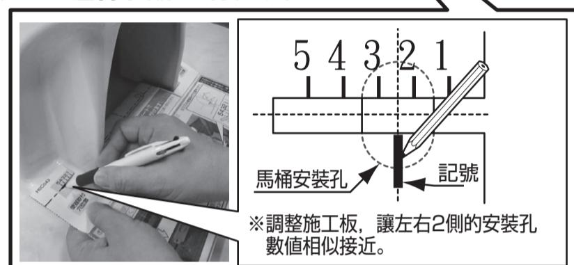
④攤開施工板，由後方壁面204mm處，對準施工板安裝基準線並放置。
