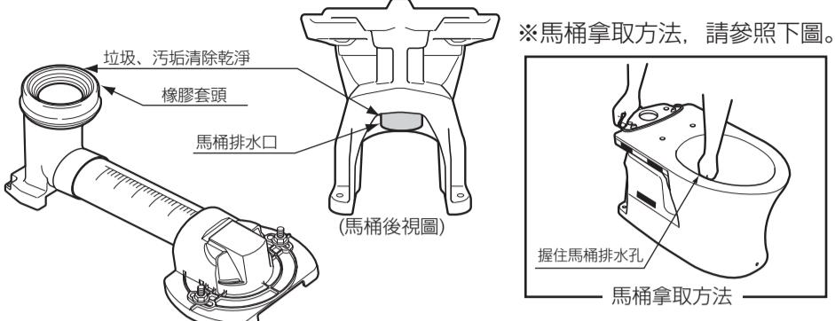
②使用木螺絲、墊圈、裝飾蓋(後)固定馬桶後側的安裝孔(2處)。
