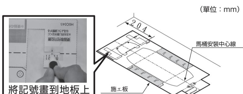
由④的作業開始，攤開施工板進行作業。
