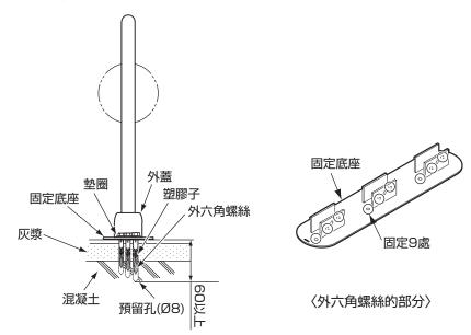
注1:請使用能在混凝土上鑽Ø8mm、深度60mm以上的預留孔的電鑽。如果電鑽的 鑽頭尺寸太大,可能造成中心偏移,無法確實固定。
