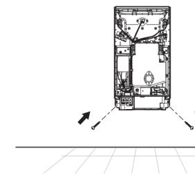
**7** 請將電源線正確接入電源端子台。(確認電源線是否能被拔出)
