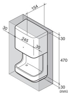
為了產品外殼、盛水盤的拆裝方便及不影響產品的功能，請在產品側面30mm、底面下方30mm、上面30mm以內留出空間，不要放置物品。此外，請勿將產品安裝在凹凸不平的牆面上。在產品作動時，不暢通的吸氣通道會使產品的功能不能充分發揮。
