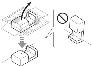
**施工板的使用方法** \* 使用時，請按照下述方式將本施工板的背面對齊。
