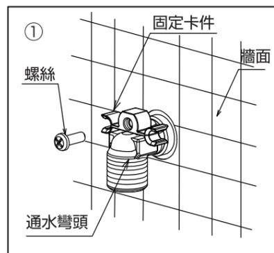
② 裝飾蓋套入通水彎頭並確實插入固定卡件直到與牆面貼合即可。
