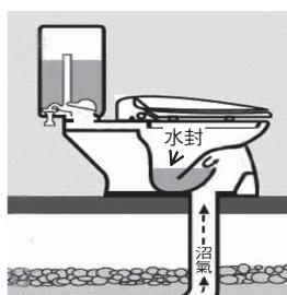
2. 馬桶安裝後放置未使用時，水封在儲水的狀態下長時間放置
