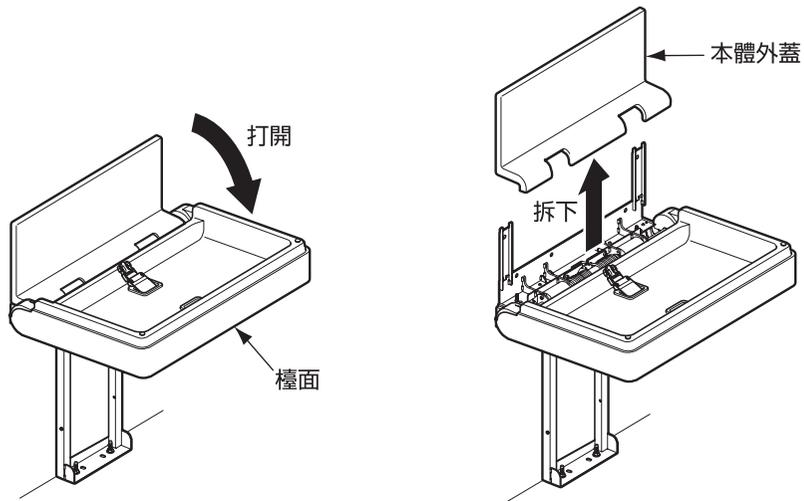
④ 依據壁面種類不同，請參照 **7** 安裝方法後，將本體框架固定於壁面。
