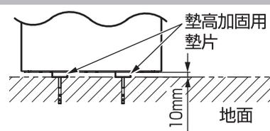
※使用另售品墊高加固用墊片(型號：YPH13057)時，請於墊高10mm處開預留孔。
