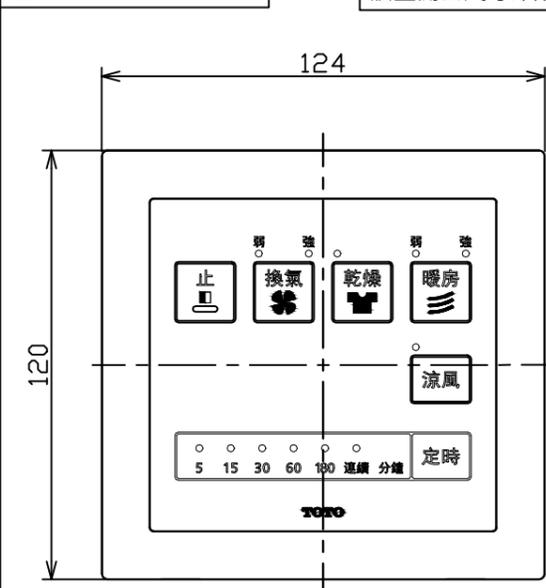
牆壁開口尺寸: H74×W93 (開口誤差範圍: H74<sup>+8</sup>, W93<sup>+5</sup>)
