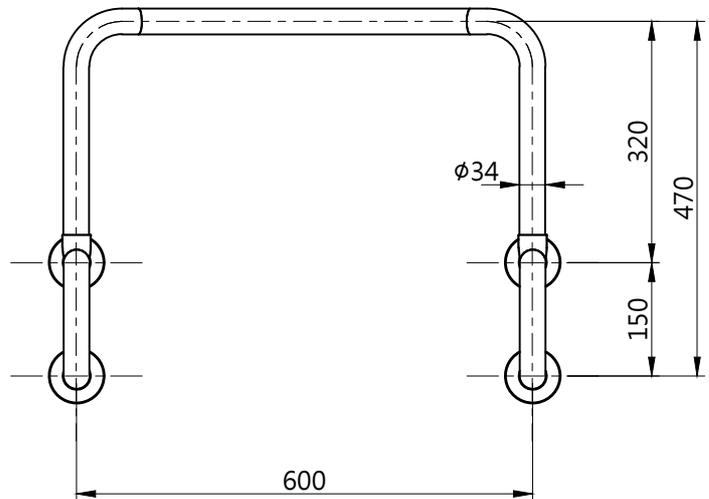
安裝扶手時，請務必使用符合施工方法、本公司所指定的安裝金具
