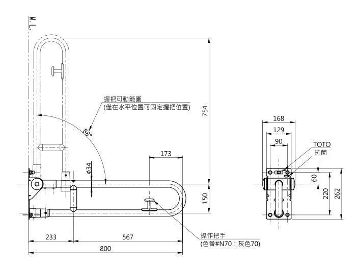
坐式馬桶用活動扶手(上掀類型) 扶手安裝用M10裝飾螺帽及彈簧墊圈同包裝 安裝扶手時,請務必使用本公司所指定的固定金具 材質:不鏽鋼表面覆蓋軟質PVC樹脂
