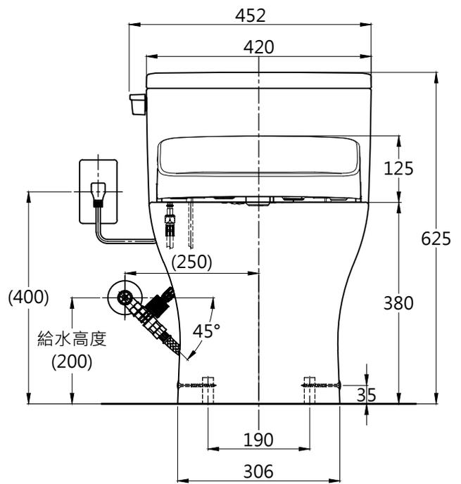
※為防止軟管折彎・止水栓適當安裝角度如圖向下45°
