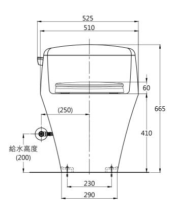
※為防止軟管折彎・止水栓適當安裝角度為水平安裝
