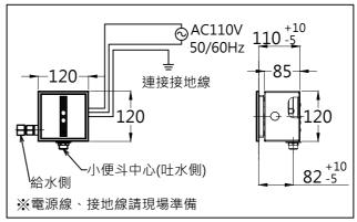
註1:埋壁進水管與安裝板請錯開·勿在同一直線上· 安裝不慎會造成漏水可能;牆內配管請自行處理。 註2:()為建議尺寸·請依使用者需求做調整。 適用於身高160~170CM·請使用者依實際身高調整。
