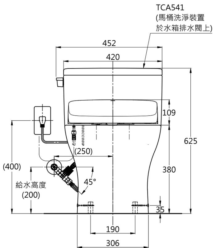
※為防止軟管折彎，止水栓適當安裝角度如圖向下45°
