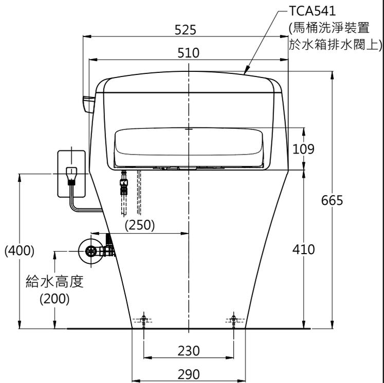
※為防止軟管折彎，止水栓適當安裝角度為水平安裝
