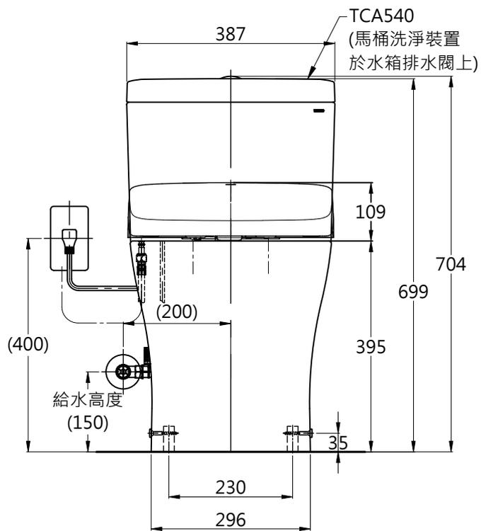
※為防止軟管折彎，止水栓適當安裝角度為水平安裝
